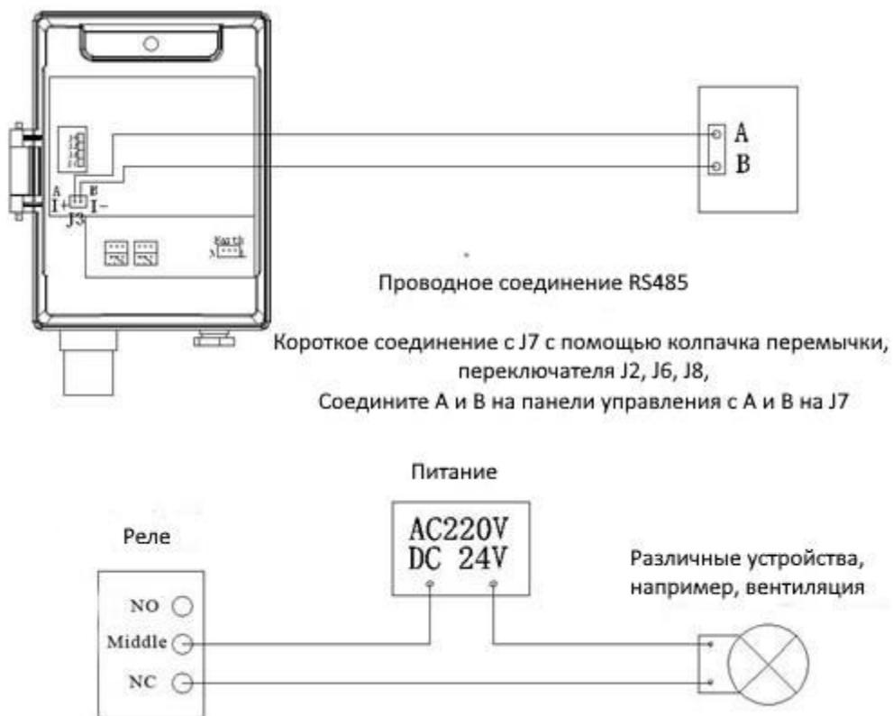
Рис. 3-2 Проводное соединение RS485
